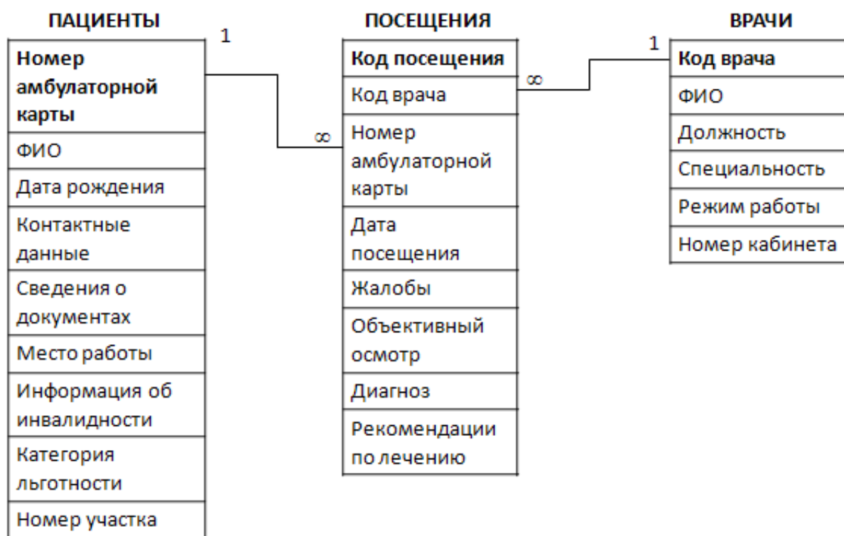
Рисунок 1 – Логическая модель данных прототипа медицинской информационной системы
