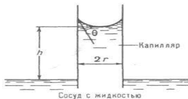
Рис. 1. Капиллярное поднятие на высоту h жидкости, смачивающей стенки капилляра радиуса r ; \theta - краевой угол смачивания.
