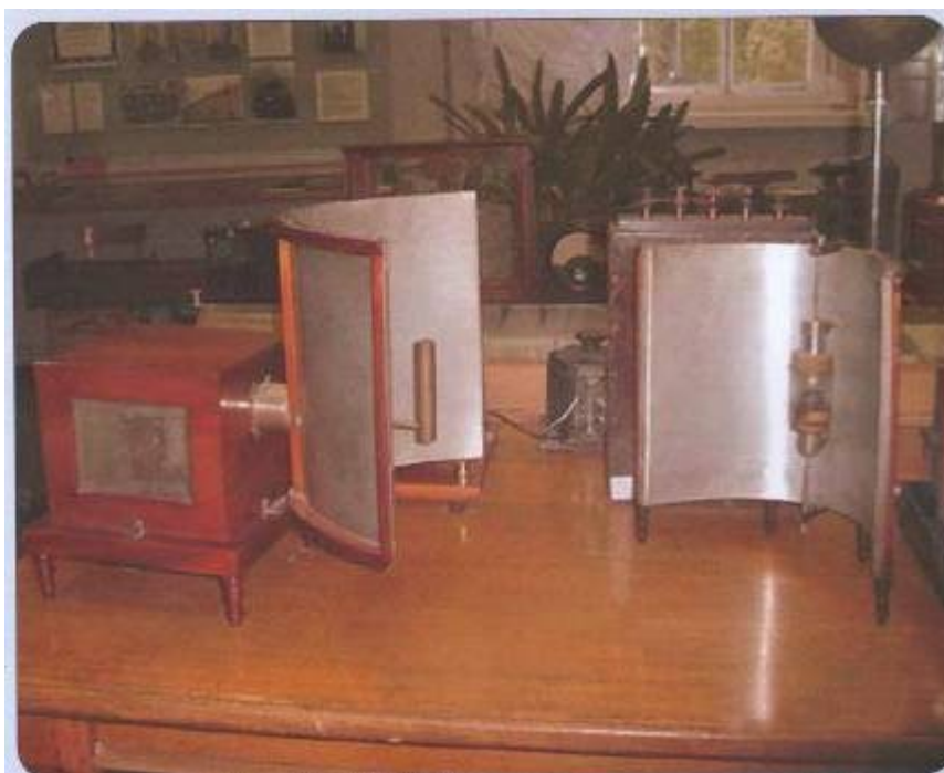
Радиоприёмник (слева) и радиопередатчик с направленными антеннами А.С. Попова. 1896 г. Мемориальный музей А.С. Попова (Санкт-Петербург)
